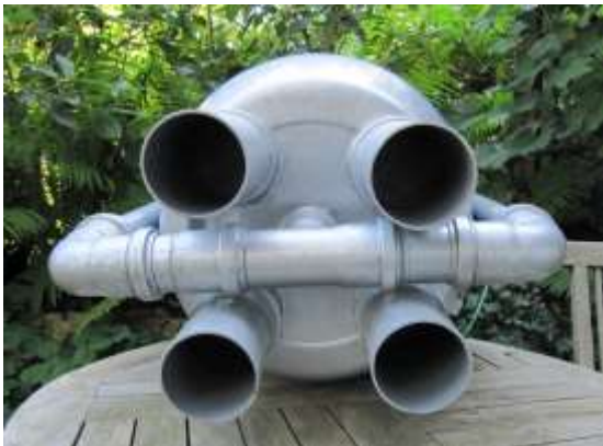
Abb. 14-19: Beispiele für einfache selbstgebaute Spiralbrüher Die Luftzufuhr erfolgt über Ausströmer in den Steigleitungen.
