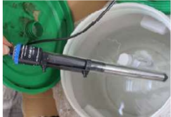
Bild Nr. 3 Mit dem Aquariumheizstab wird die Temperatur auf 22 – 28 °C reguliert
